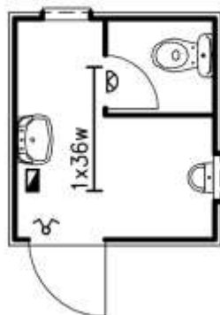
Figura n.º 10: Contentor das instalações sanitárias
